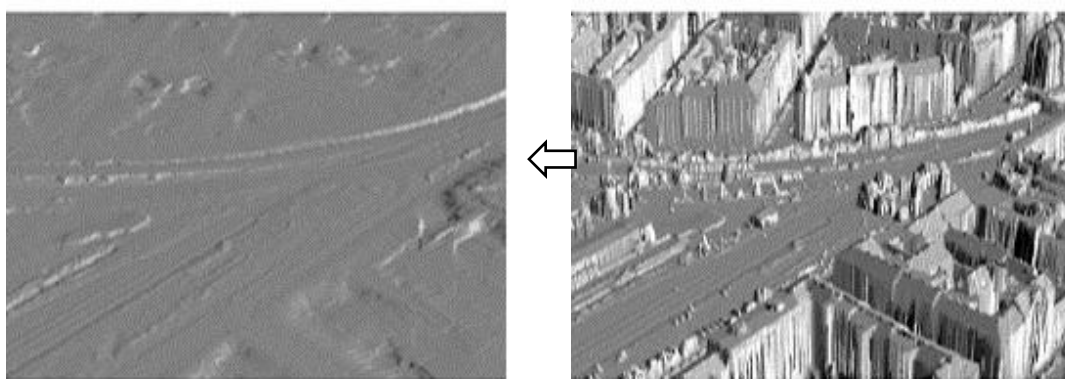
الشكل(3-43):من نموذج سطحي رقمي (DSM) إلى نموذج تضاريسي رقمي (DTM) [29]
