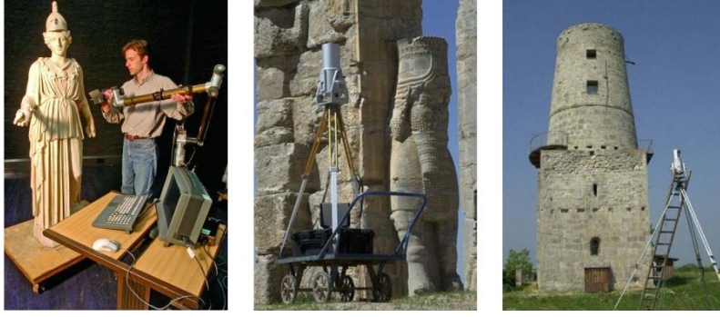
الشكل (3-29): طرق تثبيت الماسح الليزري أثناء العمل في الموقع الأثري [25]
