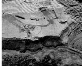
الشكل (3-33): استخدام الماسح الليزري في مسح المواقع التي تتغير بفعل عوامل الجو (تقييم تهديد الكساد الساحلي في دير ويتبي، انجلترا) [27]
