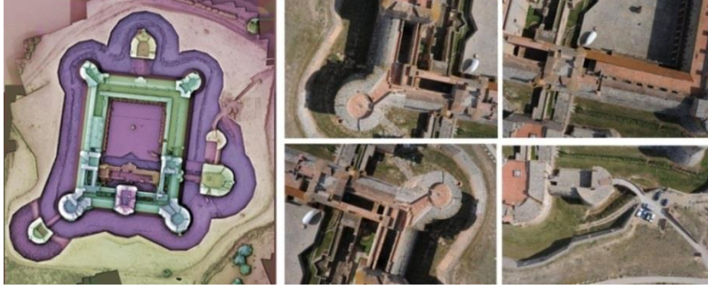
الشكل (3-3): الحصول على مسقط لقلعة سالس - فرنسا من خلال صور ملتقطة من طائرة هوليكنتر [11]
