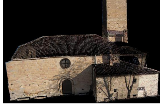
الشكل (2-5) النموذج النهائي الناتج عن استخدام المسح الليزري [32]
